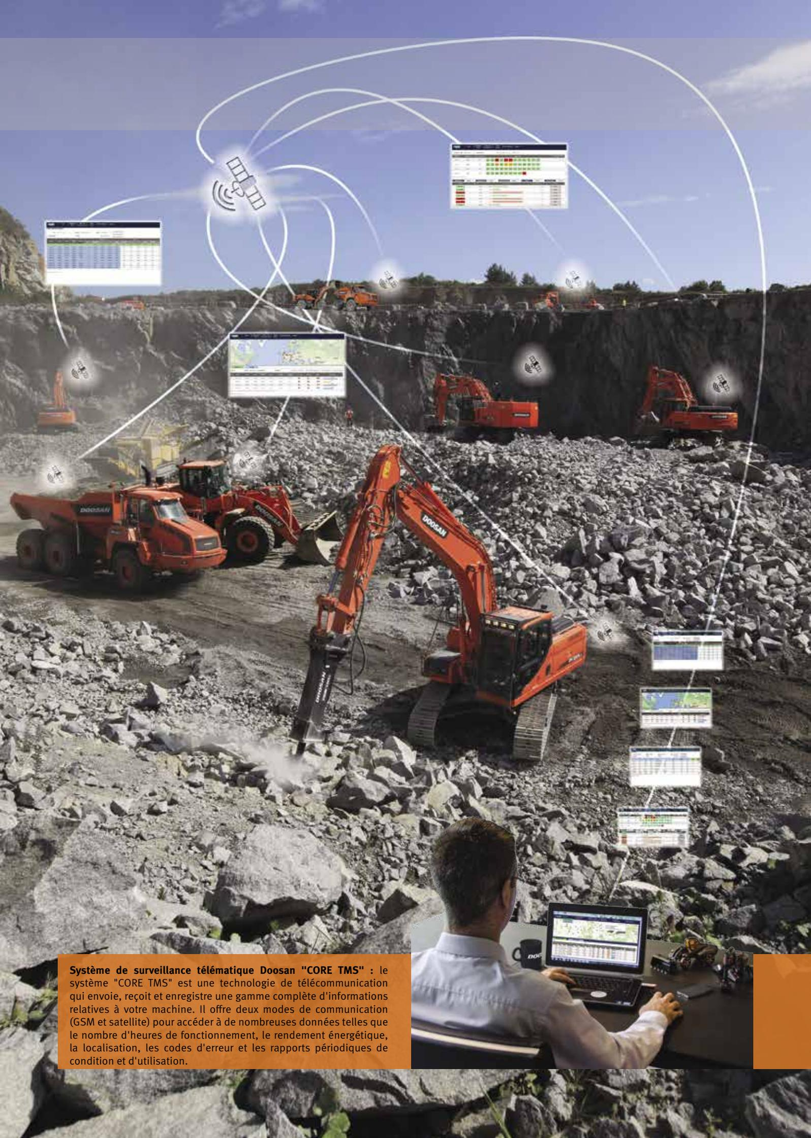
**Système de surveillance télématique Doosan "CORE TMS" :** le système "CORE TMS" est une technologie de télécommunication qui envoie, reçoit et enregistre une gamme complète d'informations relatives à votre machine. Il offre deux modes de communication (GSM et satellite) pour accéder à de nombreuses données telles que le nombre d'heures de fonctionnement, le rendement énergétique, la localisation, les codes d'erreur et les rapports périodiques de condition et d'utilisation.
