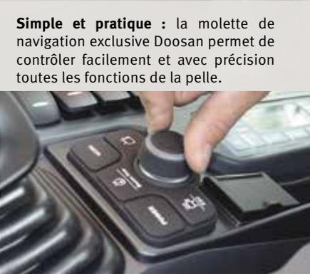
**Simple et pratique :** la molette de navigation exclusive Doosan permet de contrôler facilement et avec précision toutes les fonctions de la pelle.
