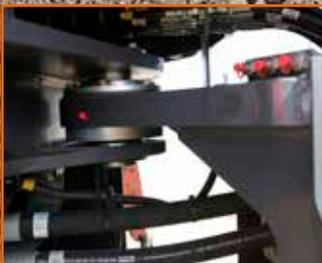
Grâce à la conception simple et épurée de l'articulation centrale, les pivots sont facilement accessibles.
