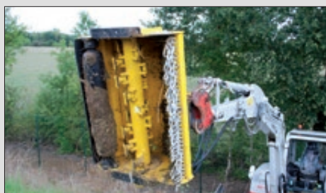
Rotor hélicoïdal avec marteaux mobiles
