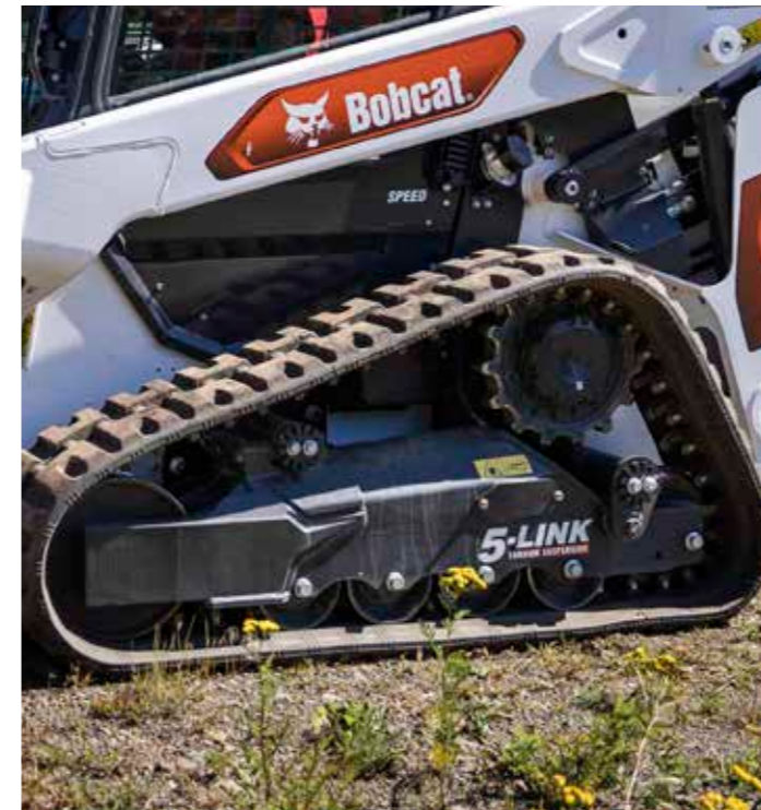
Système de suspension sur barres de torsion à 5 articulations
