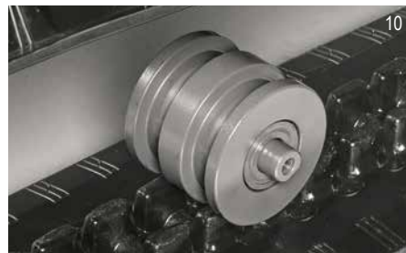
GALETS INFÉRIEURS À TRIPLES BRIDES
