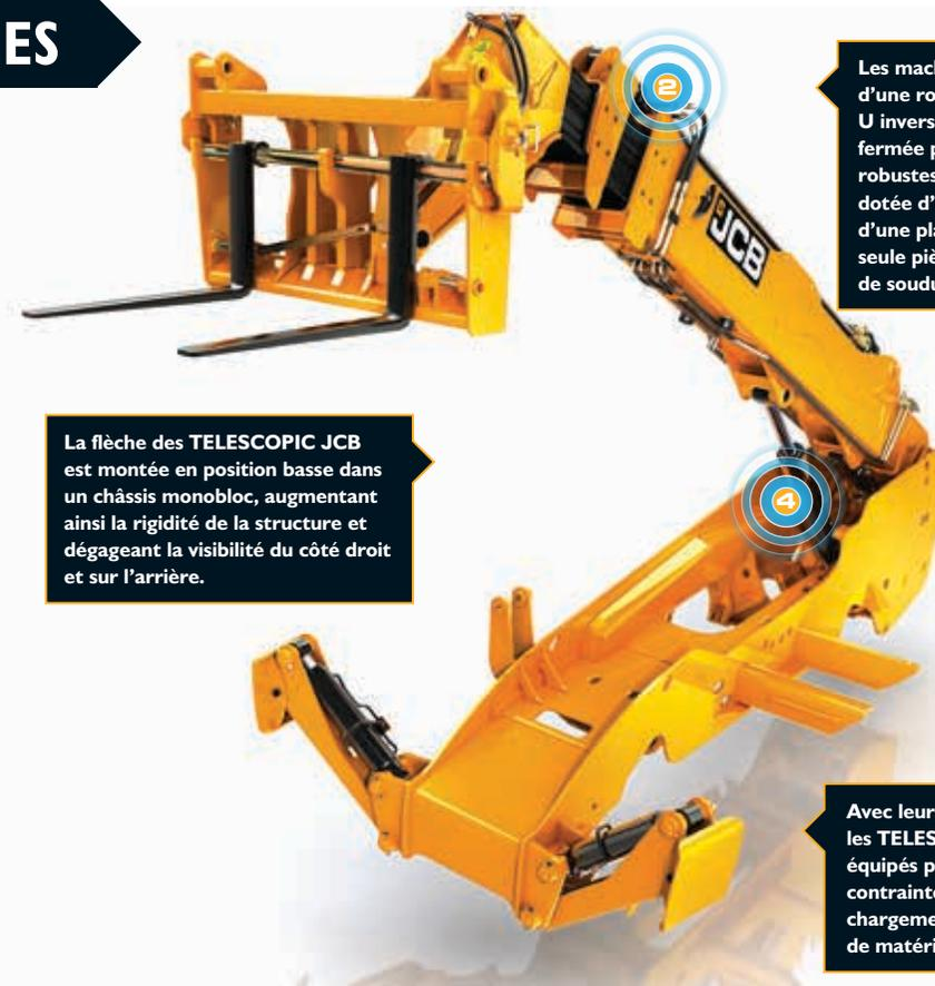
Les machines sont équipées d'une robuste flèche profilée en U inversé entièrement soudée, fermée par des plaques. Pour une robustesse accrue, la flèche est dotée d'un nez flèche intégré et d'une plaque de fermeture en une seule pièce, et elle comporte moins de soudures et de zones sensibles.
