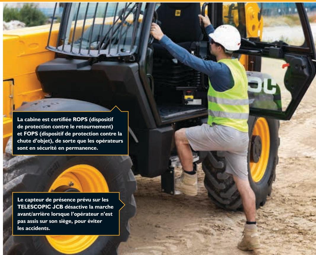
La cabine est certifiée ROPS (dispositif de protection contre le retournement) et FOPS (dispositif de protection contre la chute d'objet), de sorte que les opérateurs sont en sécurité en permanence.
