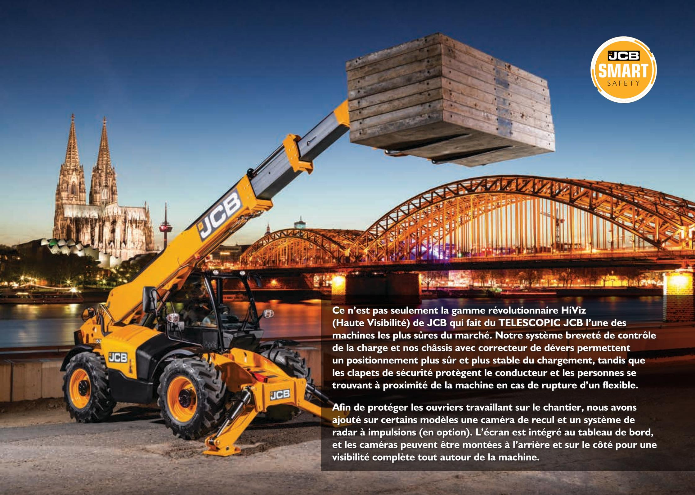
Ce n'est pas seulement la gamme révolutionnaire HiViz (Haute Visibilité) de JCB qui fait du TELESCOPIC JCB l'une des machines les plus sûres du marché. Notre système breveté de contrôle de la charge et nos châssis avec correcteur de dévers permettent un positionnement plus sûr et plus stable du chargement, tandis que les clapets de sécurité protègent le conducteur et les personnes se trouvant à proximité de la machine en cas de rupture d'un flexible.
