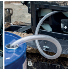
Pompe à carburant électrique
