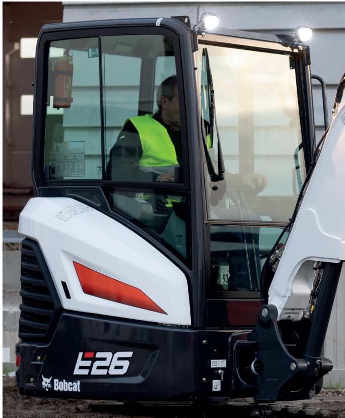
Cabine TOPS / ROPS / FOPS avec chauffage
