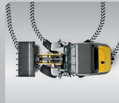
**Quatre roues directrices** : particulièrement maniable grâce à l'angle de braquage de 2 x 40°.
