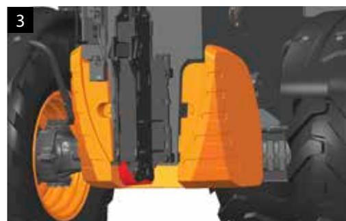
Conception monocoque du châssis avec un fond blindé sur toute la longueur pour répondre à des cycles de chargements intensifs et une protection optimale des composants
