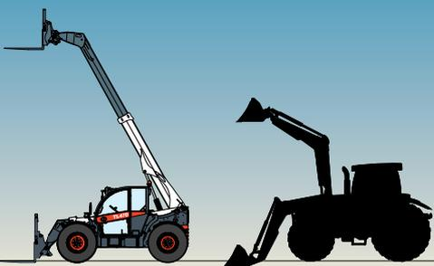
Enfin, vous pouvez exécuter vos opérations de manutention de matériaux même dans les espaces les plus restreints grâce aux quatre roues directrices de série, et aux hauteurs les plus élevées grâce à une hauteur de levage maximale de 7 m.
