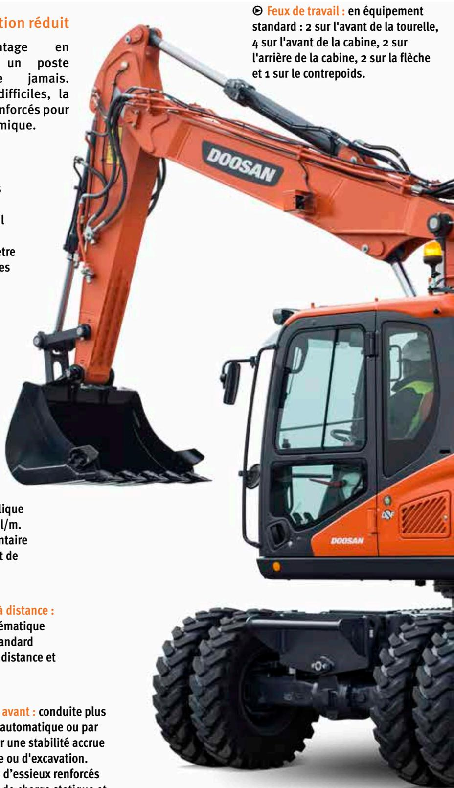
⊙ **Feux de travail** : en équipement standard : 2 sur l'avant de la tourelle, 4 sur l'avant de la cabine, 2 sur l'arrière de la cabine, 2 sur la flèche et 1 sur le contrepoids.
