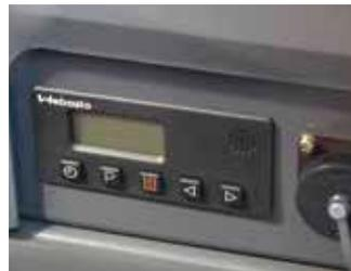
Réchauffeur autonome du circuit de refroidissement
