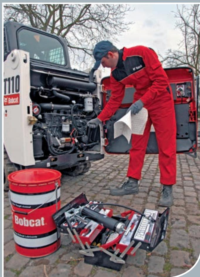
Le moteur à montage transversal et la porte arrière pivotante offrent une accessibilité totale pour l'entretien.
