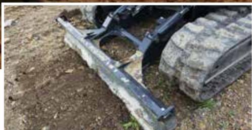
La fonction de flottement de la lame de remblayage fait partie de l'équipement standard de ces nouvelles pelles compactes afin que même les opérateurs débutants puissent niveler rapidement et proprement.
