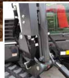
Clapets de sécurité de charge sur les vérins de flèche et de balancier (standard) pour une sécurité maximale en toutes circonstances
