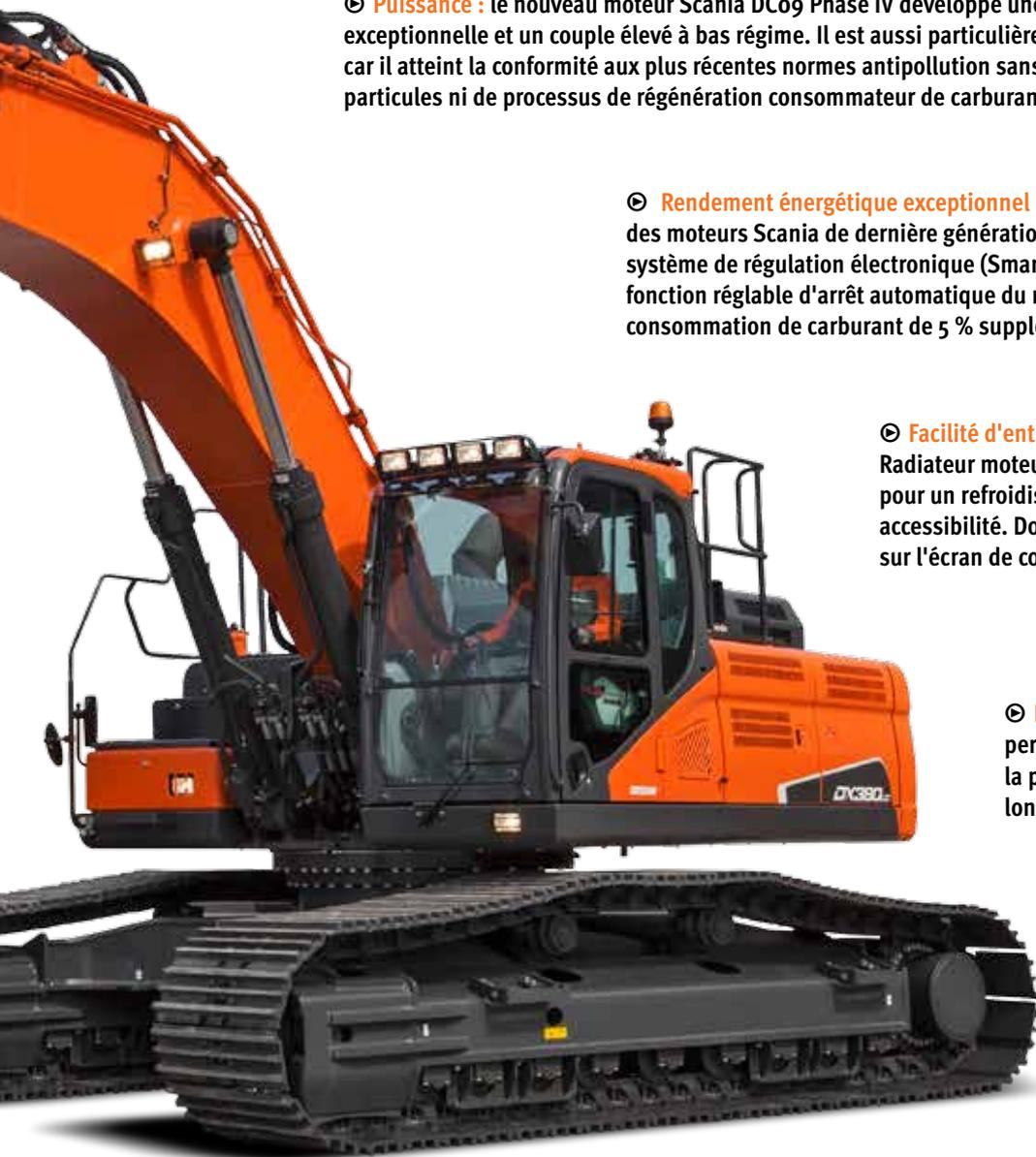
☉ **Train de chenilles particulièrement durable** : galets supérieurs en acier forgé durci en profondeur, galets inférieurs à bain d'huile, barbotins en acier trempé, maillons de chenille en acier trempé durci en profondeur, axes étanches et graissés à vie.
