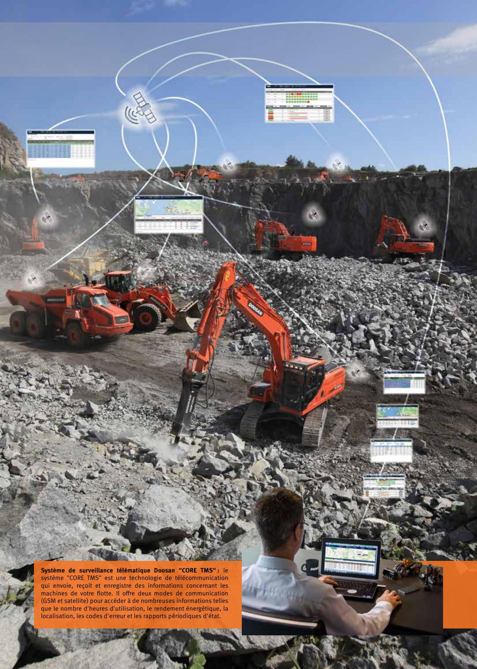
**Système de surveillance télématique Doosan "CORE TMS"** : le système "CORE TMS" est une technologie de télécommunication qui envoie, reçoit et enregistre des informations concernant les machines de votre flotte. Il offre deux modes de communication (GSM et satellite) pour accéder à de nombreuses informations telles que le nombre d'heures d'utilisation, le rendement énergétique, la localisation, les codes d'erreur et les rapports périodiques d'état.
