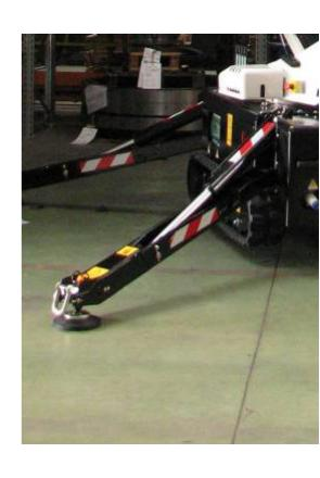
Dispositifs lumineux de signalisation de la position installés sur les bras porte-stabilisateurs
